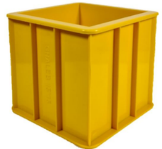
قالب مکعبی نمونه برداری بتن ۱۵×۱۵×۱۵ سانتی متر
